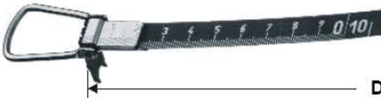
Maßanfang „D“ , das Maß beginnt am Beschlag, dieser ist mit einem ausklappbaren Haken ausgestattet, so daß der Bandanfang eingehängt werden und eine Person alleine messen kann.
