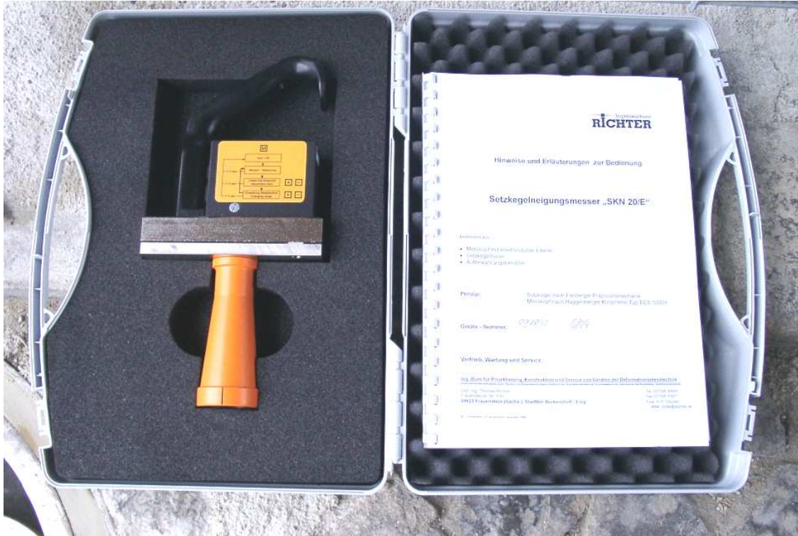
Abbildung 1 Klinometer (Neigungssensor mit Konushülse) im Transportkoffer
