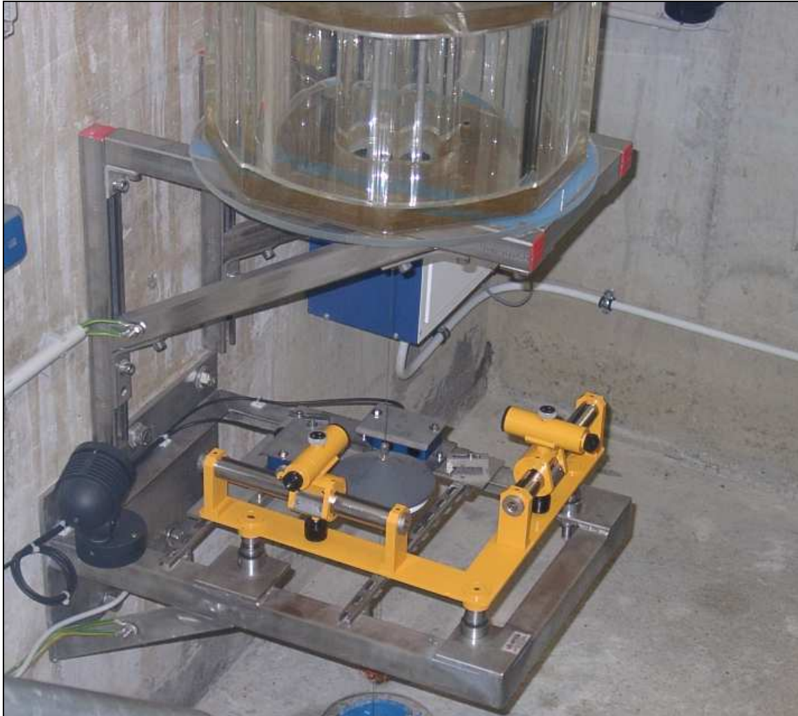
Abbildung 1 Schwimmerbehälter und Ableseeinrichtung Koordimeter FPM
